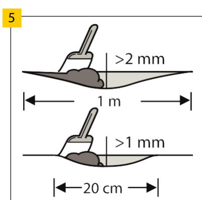
Uistite sa, že je podklad úplne rovný. Všetky nerovnosti podkladu presahujúce 1 mm a dĺžie ako 20 cm, alebo presahujúce 2 mm a dĺžie ako 1 m sa musia vyrovnátať. Skontrolujte, či je potrebné použiť základný náter alebo izolačný materiál. Na prípravu dokonalého podkladu naneste na celý povrch cementovú maltu alebo samonivelačnú hmotu.
