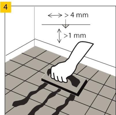
Ak sa robí inštalácia na podklad pokrytý keramickými obkladačkami, vyplňte škáry s medzeračmi širšími ako 4 mm a hlbšími ako 1 mm odolnou výplňou škár, napr. gumovou špárovacou hmotou. Pokladka na dlaždice so špárovacou hmotou nie širšou ako 5 mm a nie hlbšou ako 1 mm je povolená bez použitia vyrovnávacej hmoty, ak sa ako podklad použije Multiprotec Super Hardlay alebo Vinclic Super Solid.
